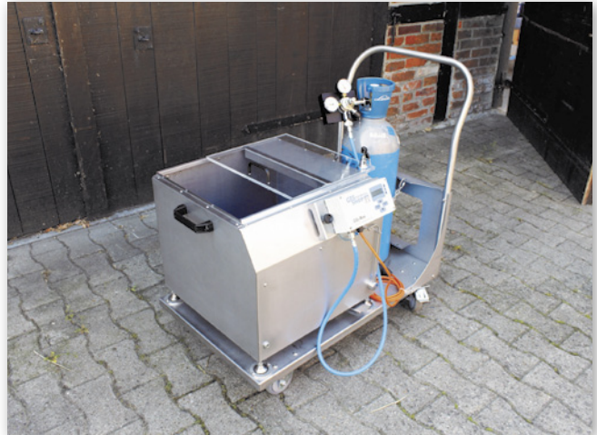
Abbildung 14: CO 2 -Betäubungsgerät für Ferkel ≤ 5 kg (Quelle: GFS)
